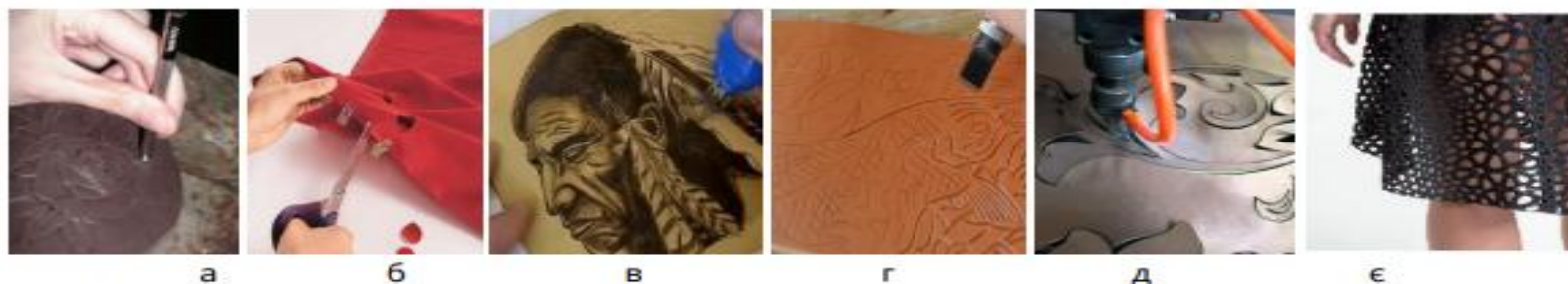
Рис. 5. Приклади виготовлення перфорації матеріалів різними способами: а – тиснення; б – ручна перфорація; в – пірографія; г – гравіювання; д – лазерна, е – 3D друк
