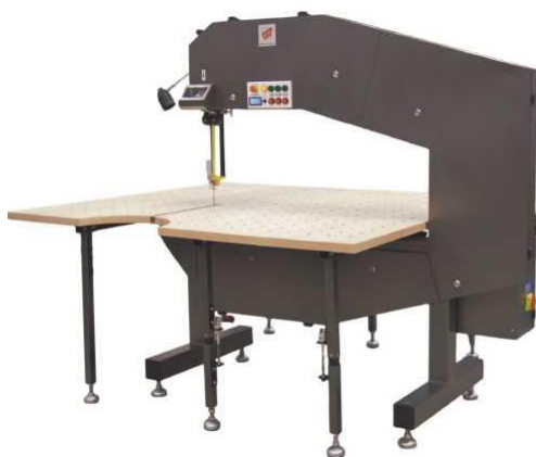
Рис. 5.5 - Стаціонарні розкрійні машини чотирьохшківні: а) - зовнішній вигляд; б) - принципова схема
